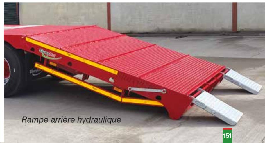
*Rampe arrière hydraulique*
