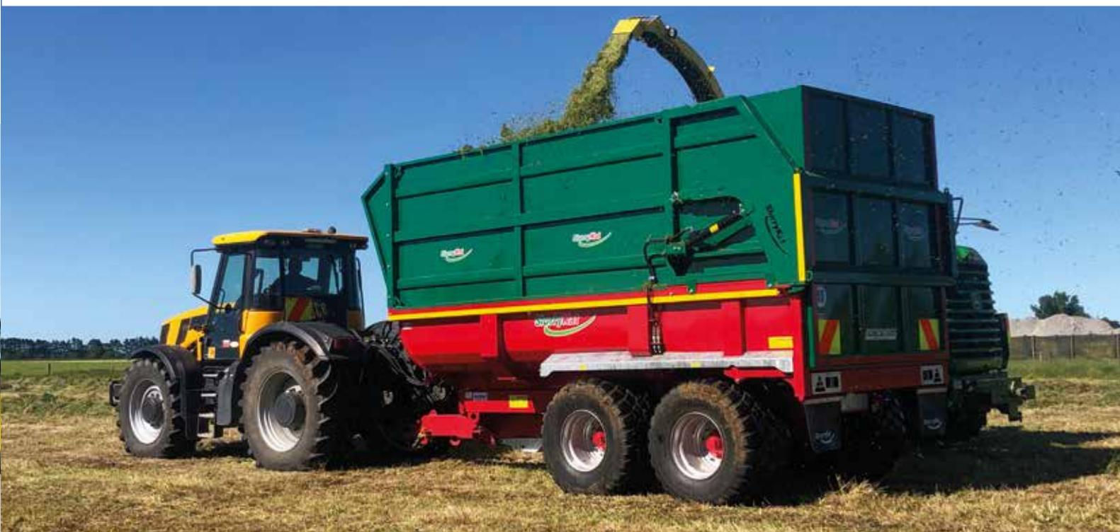
Lorsque le kit ensilage (panneaux verts) est installé sur la remorque, la porte TP reste en position ouverte à plat et à l'aide d'une vanne 3 voies, l'huile est dirigée vers la porte à ensilage.
