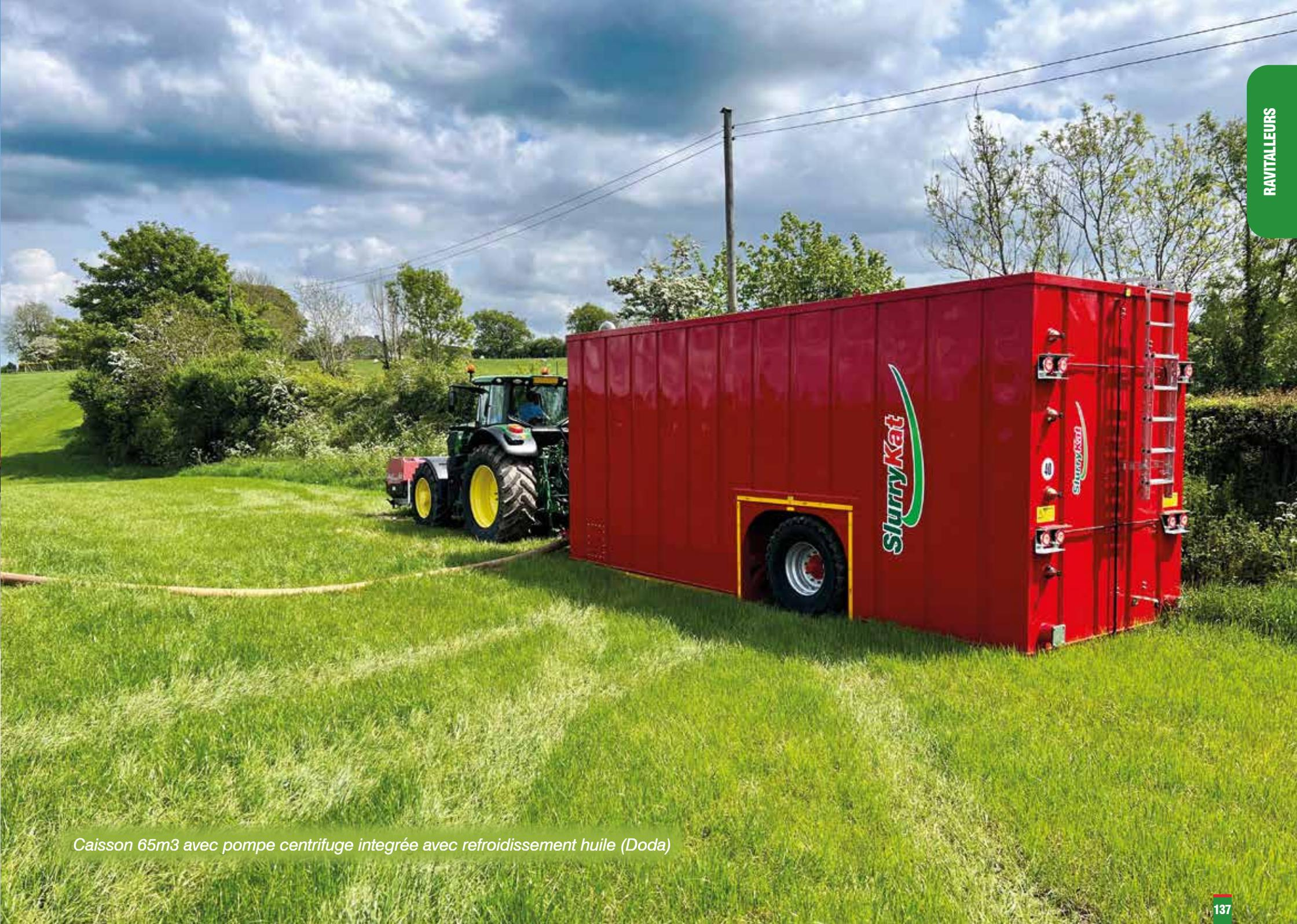
*Caisson 65m<sup>3</sup> avec pompe centrifuge intégrée avec refroidissement huile (Doda)*
