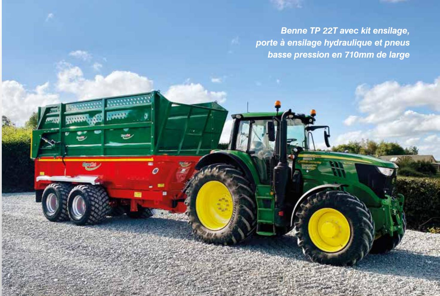
*Benne TP 22T avec kit ensilage, porte à ensilage hydraulique et pneus basse pression en 710mm de large*
