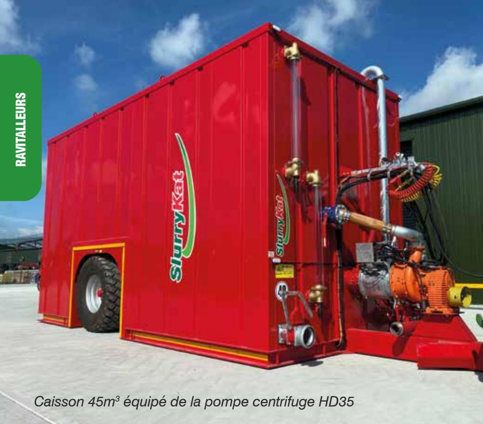
Caisson 45m<sup>3</sup> équipé de la pompe centrifuge HD35
