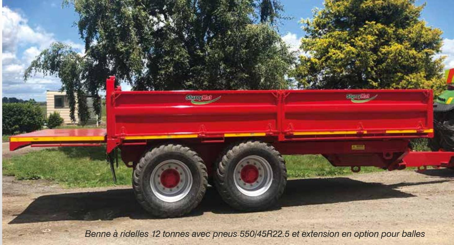
*Benne à ridelles 12 tonnes avec pneus 550/45R22.5 et extension en option pour balles*
