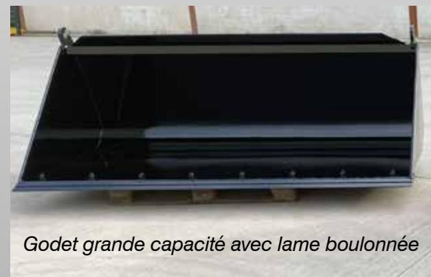
*Godet grande capacité avec lame boulonnée*
